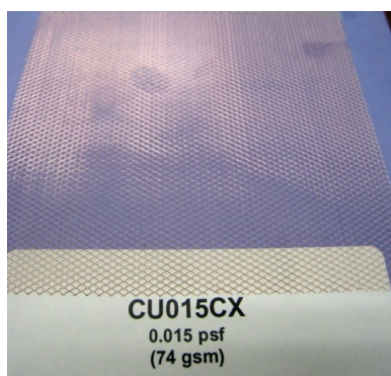
Fig.4.5-1 LSP の例 (Dexmet Co.)
