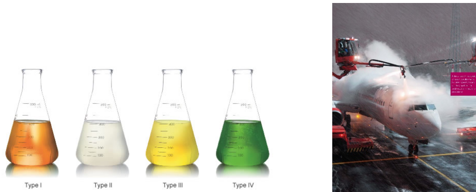
Fig.4.2-3 使用される防除氷液（左）と地上での防除氷作業（右） 4.2.6)
