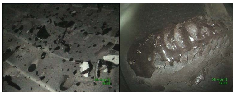
Fig.4.6-1 火山灰吸込み試験後の燃焼器（左）とタービン翼（右）の写真 4.6.4)
