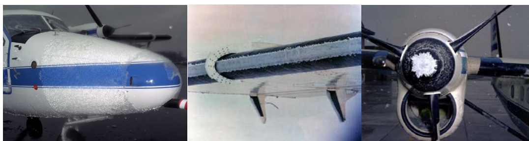
Fig.4.2-2 機首（左）翼（中）スピナー（右）への着氷（右）（4.2.3）-（4.2.5）
